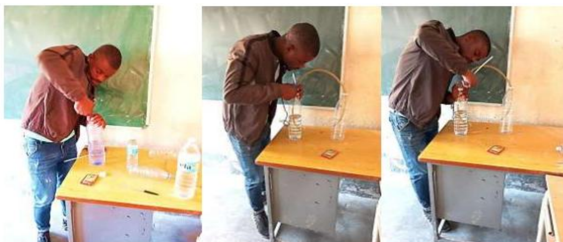
Figura 2a. Montagem do sistema de vasos comunicantes.
