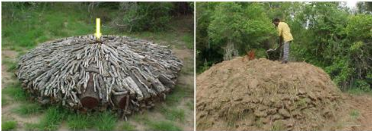
Figura 9. a) Preparação e cobertura do forno; b) forno Casa mansa. Fonte: (Pereira, 2002)
